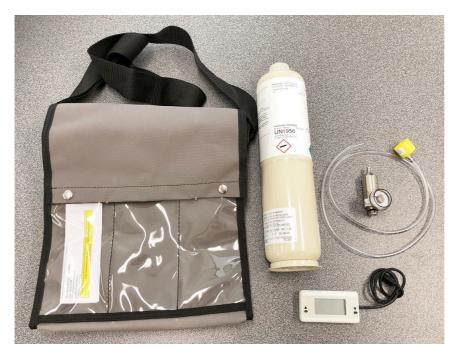
CO GAS SENSOR CALIBRATION & TESTING PACK.
