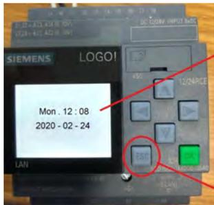
NOW PRESS THE **ESC** BUTTON TO CAUSE THE 1ST INTERNAL MENU SCREEN TO APPEAR.
