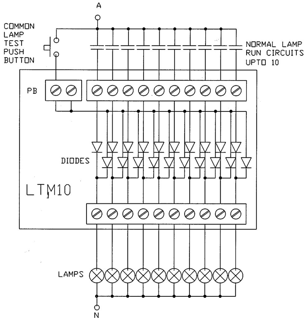
THIS CIRCUIT LAMPS ALWAYS ONLY GET HALF WAVE POWER EITHER FROM LAMP TEST BUTTON OR CONTROL CIRCUIT
