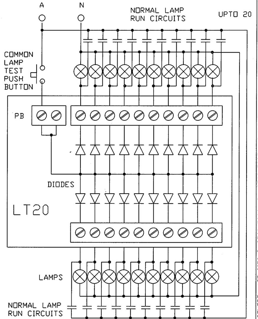
THIS CIRCUIT LAMPS GET FULL AC POWER FROM NORMAL RUN MODE CIRCUIT BUT ONLY HALF WAVE FROM COMMON LAMP TEST BUTTON
